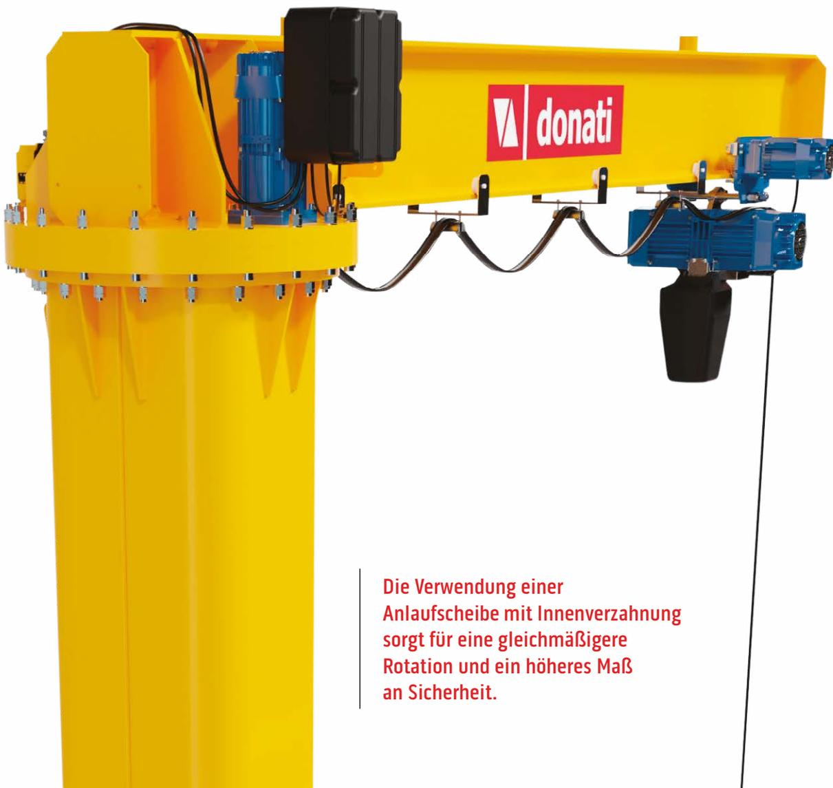
Die Verwendung einer Anlaufscheibe mit Innenverzahnung sorgt für eine gleichmäßigere Rotation und ein höheres Maß an Sicherheit.
